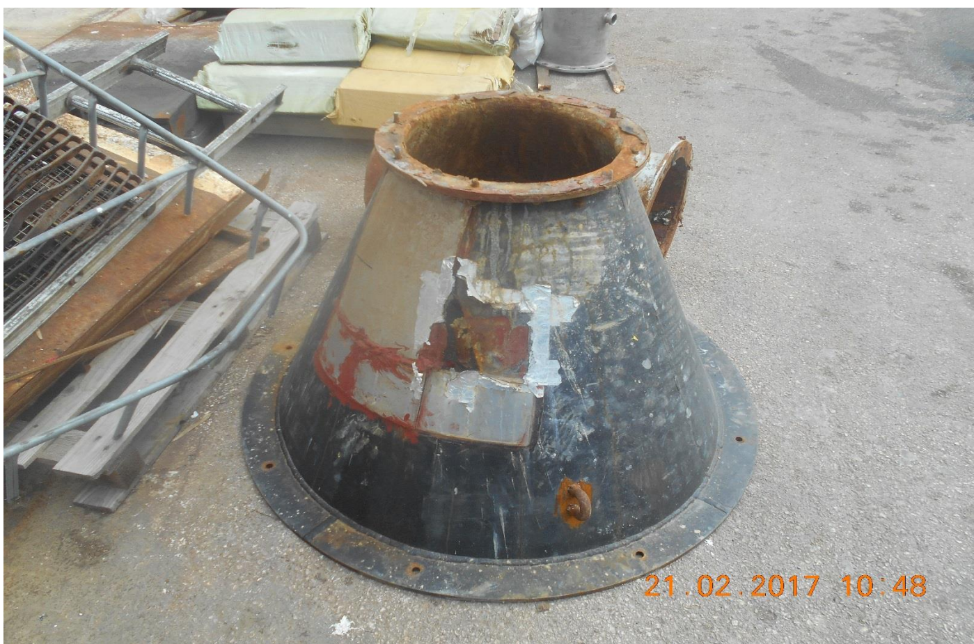
Φωτό 1071 Εξαχθείς εξοπλισμός προς αντικατάσταση (χοάνη)
