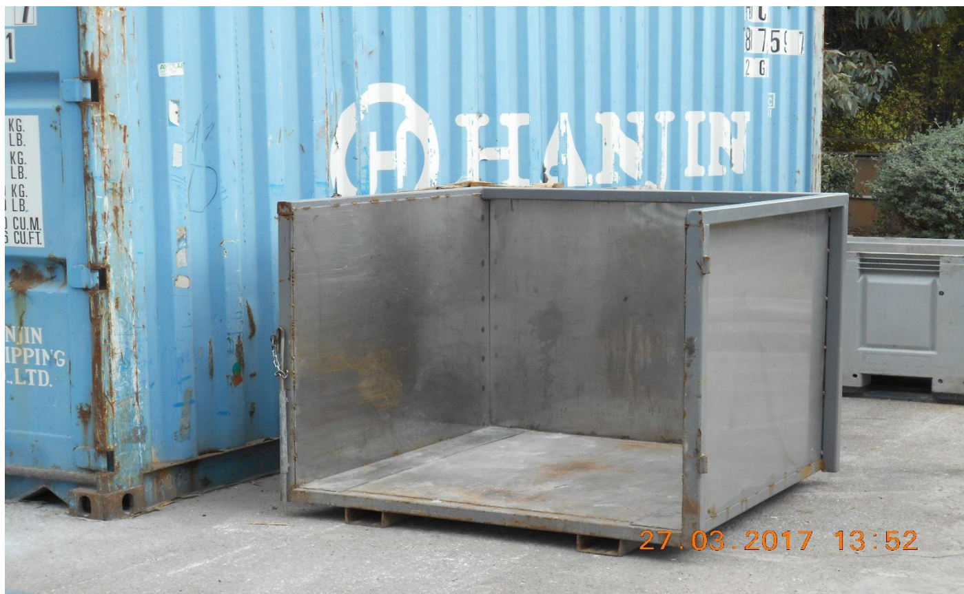
Φωτό 1343:Ειδική κατασκευή για την ασφαλή μεταφορά της τέφρας στην πλατφόρμα προσωρινής αποθήκευσης
