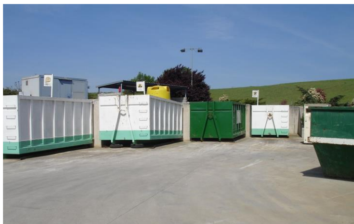
Εικόνα 4.4.3: Containers υποδοχής ογκωδών αντικειμένων, ΑΕΚΚ, συσκευασίες χρωμάτων.
