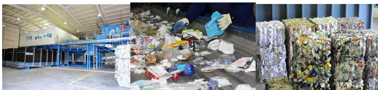
Εικόνα 3.2.1.4: Διαλογή στο ΚΔΑΥ, και συμπίεση-δεματοποίηση αποβλήτων συσκευασιών
