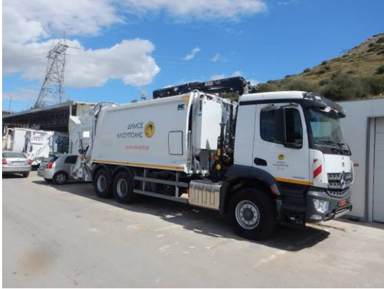
Εικόνα 4.7: Α/Φ οχήματα για συλλογή ημιυπόγειων κάδων
