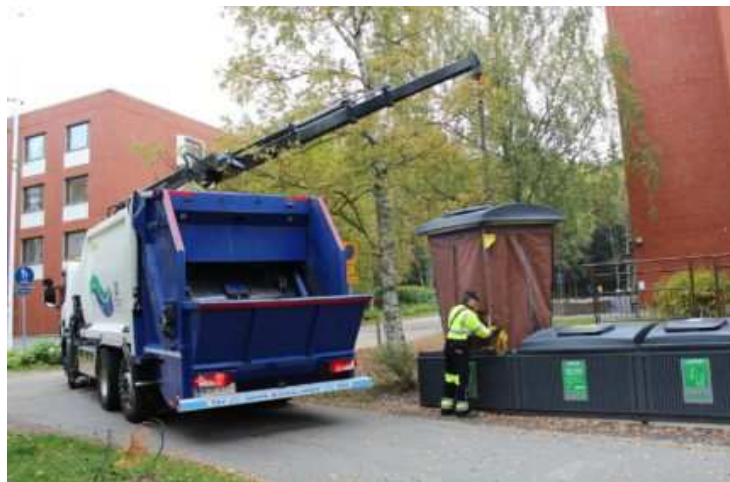
Εικόνα 5.1: Απορριμματοφόρο με υδραυλικό ανυψωτικό μηχανισμό (γάντζο)
