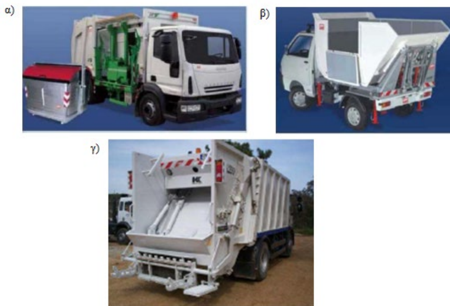
Εικόνα 41: Οχήματα συλλογής και μεταφοράς α) πλάγιας φόρτωσης, β) δορυφορικά, γ) κλειστά με συμπίεση
