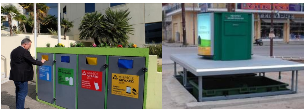
Εικόνα 9: Γωνιές ανακύκλωσης με συστοιχίες κάδων (υπέργειες και υπόγειες)
