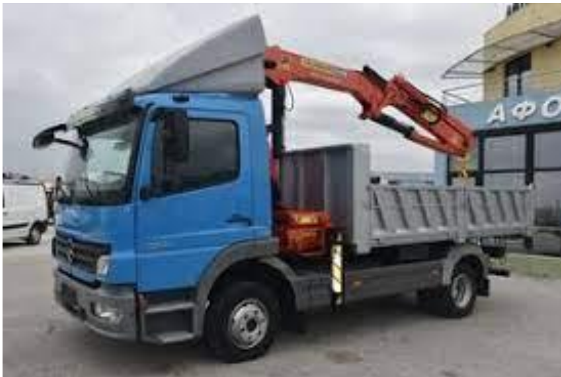
Εικόνα 13: Φορτηγό με γερανό και αρπάγη
