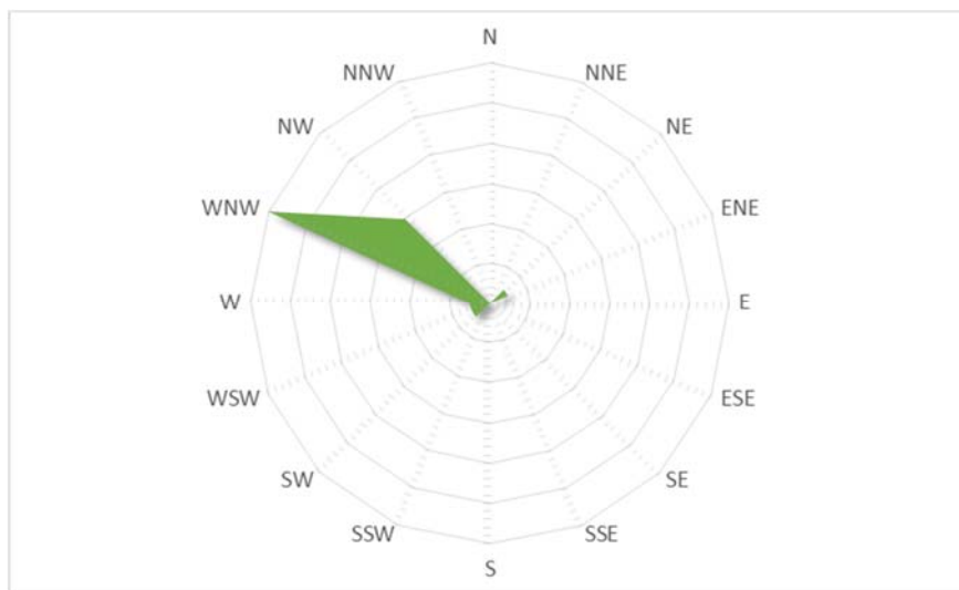
Σχήμα 6.6: Πολικό διάγραμμα κατανομής σχετικών συχνοτήτων διεύθυνσης ανέμου του μετεωρολογικού σταθμού των Άνω Λιοσίων του ΕΕΑ για τον μήνα Αύγουστο 2017.
