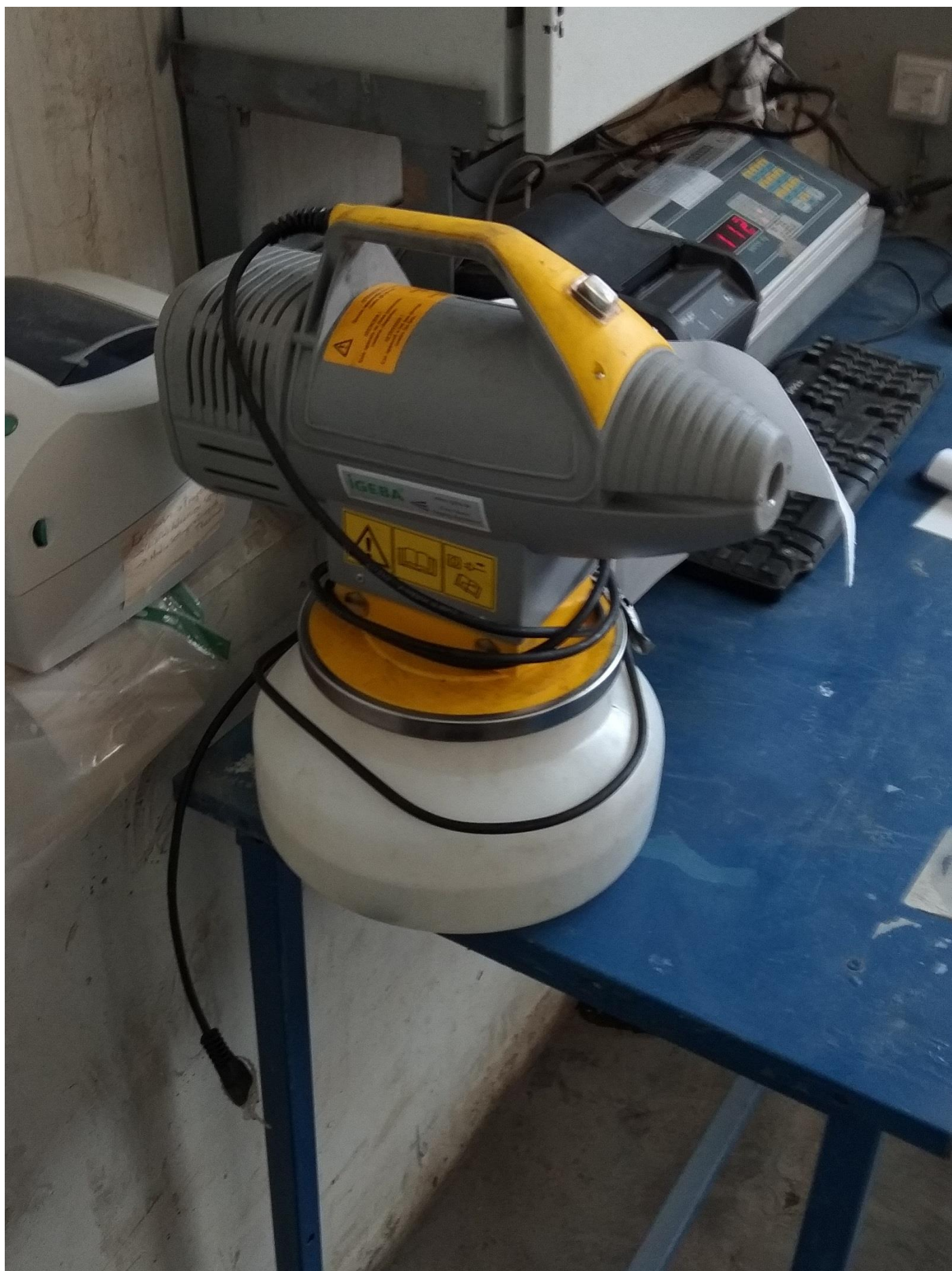
Φωτο 91: Εξοπλισμός απολύμανσης ψυγείων εγκατάστασης
