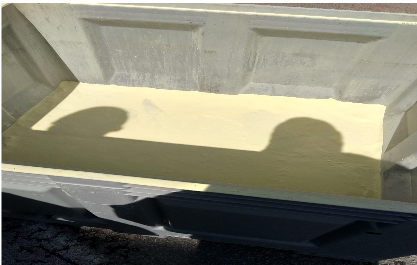
Φωτο 94: Υλικό πυροσβεστήρα ξηράς σκόνης
