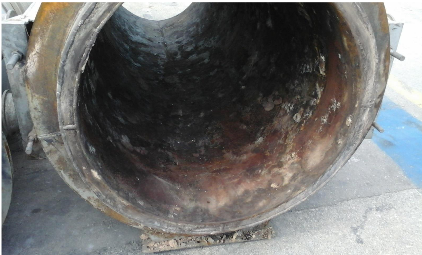
Φωτο 62: Φθαρμένο στοιχείο εναλλάκτη
