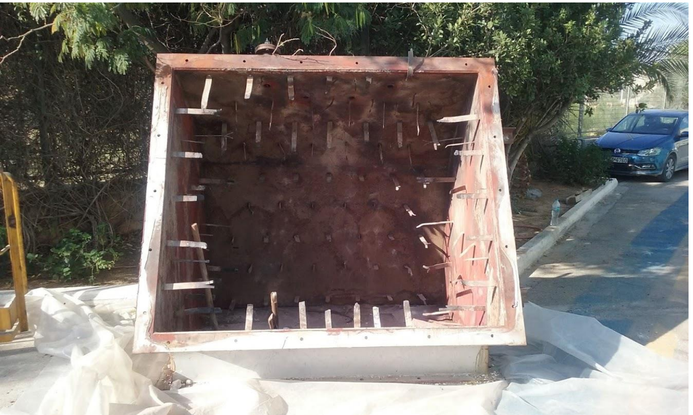
Φωτό 57: Τετράγωνη διαστολή μετάκαυσης μετά από αφαίρεση πυρίμαχης επένδυσης
