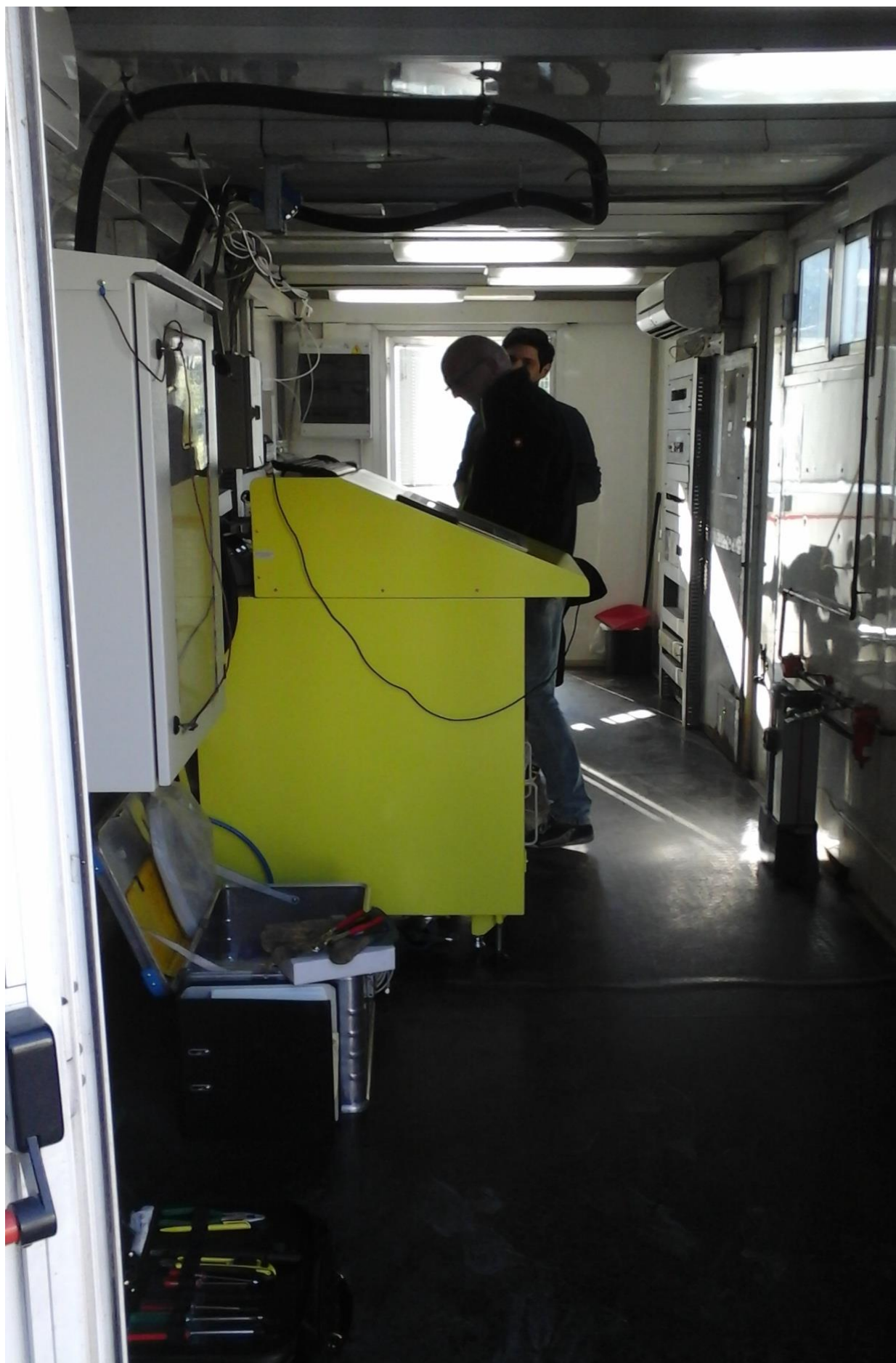
Φωτο 53: Συντήρηση αναλυτή αερίων ρύπων
