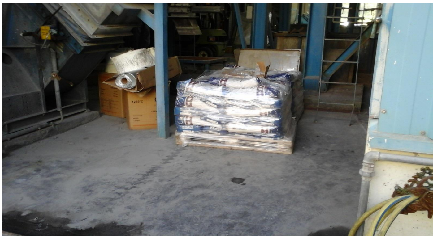
Φωτο 29 Συσκευασίες ενεργού άνθρακα (υλικό εξουδετέρωσης ρύπων)
