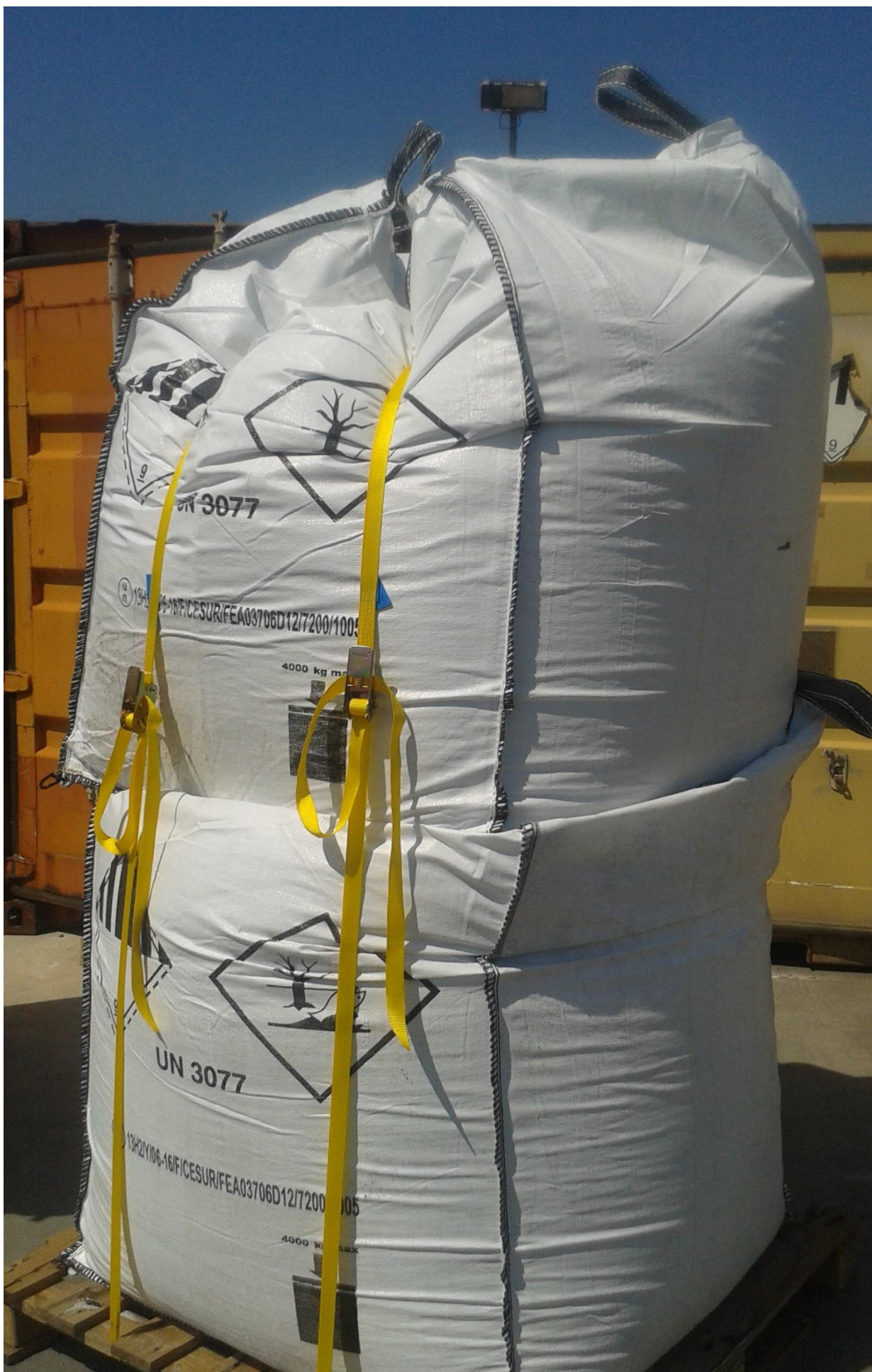
Φωτο 64: Ιπτάμενη τέφρα προς μεταφορά σε μονάδες επεξεργασίας του εξωτερικού
