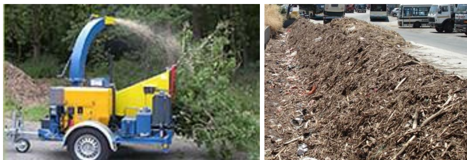
Εικόνα 34 Τεμαχιστής κλαδεμάτων και σειράδι κομποστοποίησης
