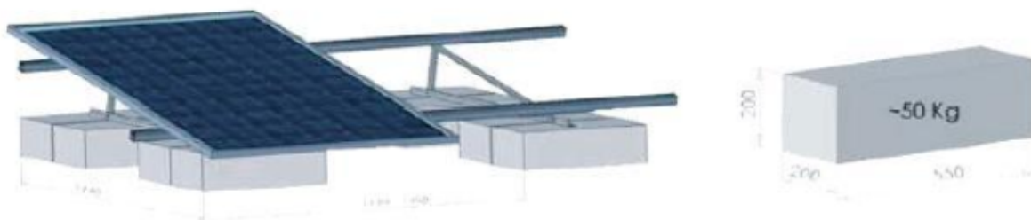
Εικόνα 14: Σχηματική απεικόνιση συστήματος στήριξης επί κυττάρου ΧΥΤΑ
