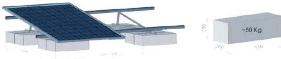
Εικόνα 14: Σχηματική απεικόνιση συστήματος στήριξης επί κυττάρου ΧΥΤΑ
