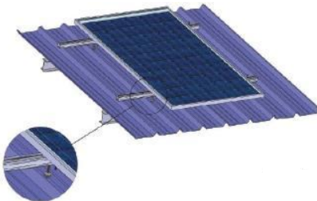
Εικόνα 16: Ενδεικτικός τρόπος εγκατάστασης Φ/Β επί του βιομηχανικού στεγάστρου της ΕΜΑΚ
